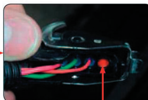
Pino 5 - Rotação do motor
