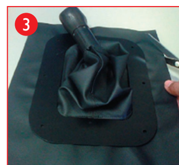
Corte do excesso de material da Coifa.
