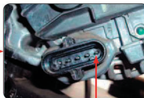
Pino 5 - Rotação do motor
